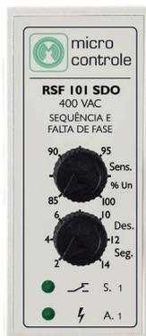
Relé de sequência e falta de fase para proteção de motores trifásicos contra quebras de fase, sequência invertida das fases do motor, atraso à desoperação e à operação.
