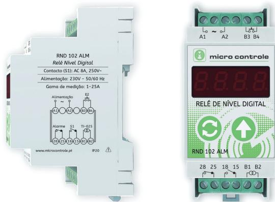
**Relé de controlo de nível em função da intensidade do consumo da bomba submersível, com auto-calibração e conta horas de funcionamento da eletrobomba.**
