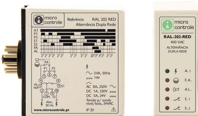
Relé de alternância para comando alternado de duas eletrobombas, e controlo de falta de água na rede de abastecimento.
